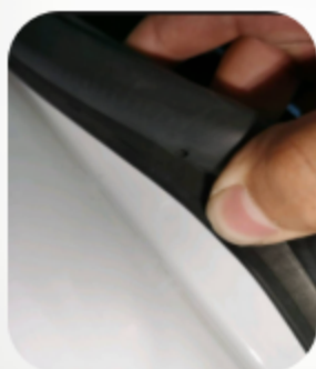
Left front door frame edge sealing
