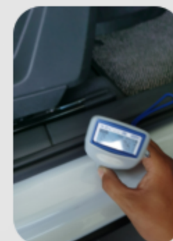
Inner side of right front bottom edge beam (defect) Внутренняя сторона балки передней правой стороны (дефект)
